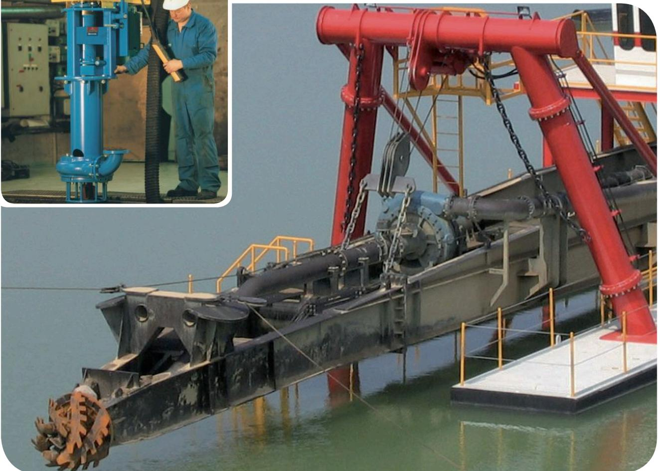
Die Bereiche höchster Beanspruchung (z. B. auf der Saugseite) sind mit besonders widerstandsfähigen Legierungen ausgestattet. Je nach Anwendung liefert Metso die schweren Pumpen in speziellen Sonderlegierungen.
