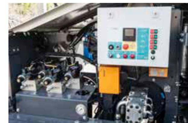
Das Motormodul des Lokotrack ST verfügt über ein bedienerfreundliches Steuerpult und ist für die tägliche Wartung gut zugänglich.
