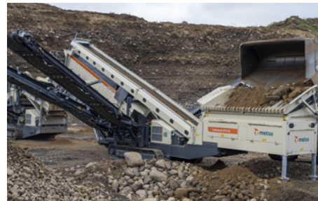
Großer Aufgabebunker ermöglicht einen geschlossenen Kreislauf.
