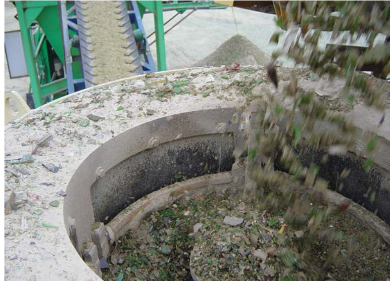
Glas kann mit dem Barmac VSI der B-Serie zerkleinert und recycelt werden.
