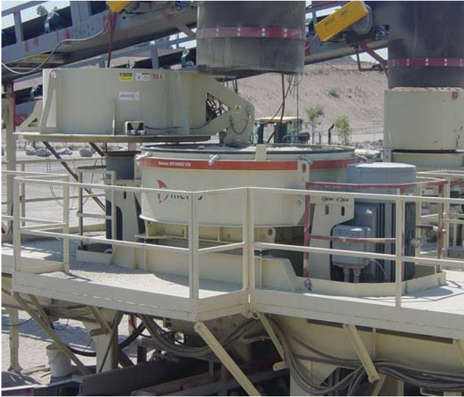
Die Hebevorrichtung für das Oberteil des Barmac VSI der B-Serie ermöglicht einen einfachen Zugriff bei Wartungsarbeiten und minimiert so Ausfallzeiten.
