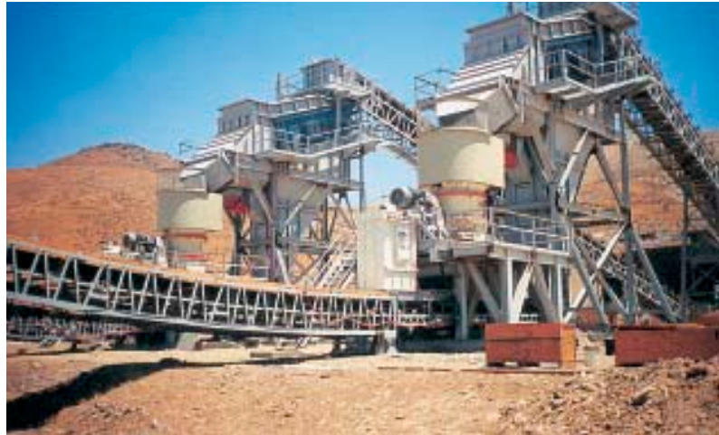
Nordberg GP500S Kreiselbrecher in den USA.
