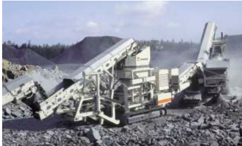
Nordberg LT300GP Mobilbrecher in einer dreistufigen Mobilanlage in Finnland.
