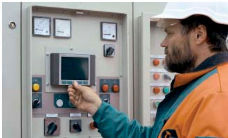
IC50 Automation in einem Lokotrack Mobilbrecher.
