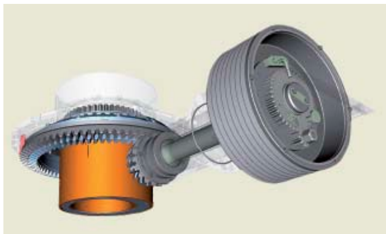
Für die GP300 und GP300S Kreiselbrecher gibt es jetzt als Option die Einstellung des Brechhubs von außen durch einfache Veränderung der Exzenterbuchsen-Positionen.
