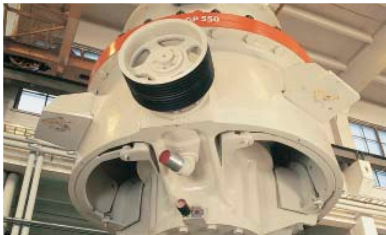
GP-Kreiselbrecher benötigen durch die optimierte Kolbenkonstruktion nur geringe Einbauhöhen.
